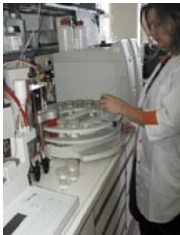
La seule et dernière intervention manuelle: la mise en place des échantillons sur le passeur d'échantillons.
