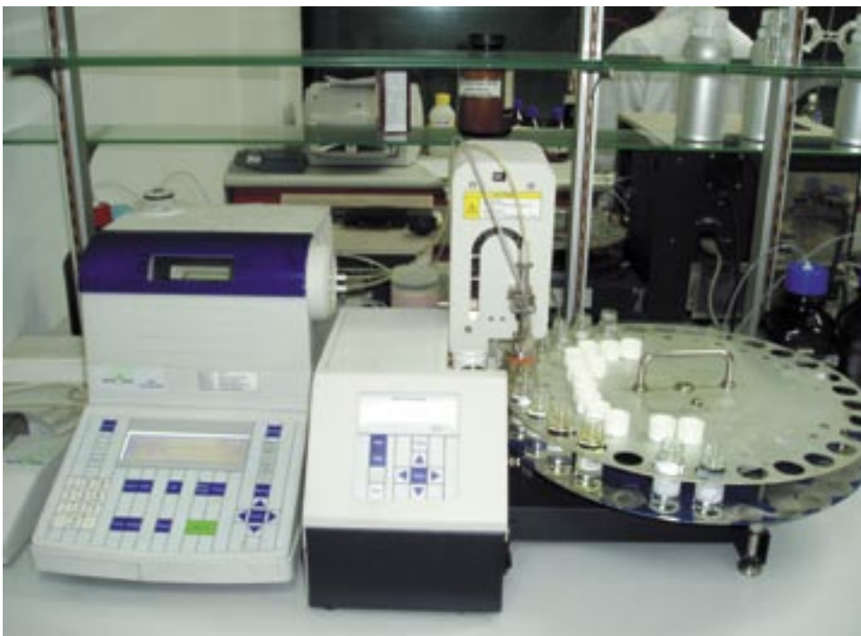
Appareil de mesure combiné DR et unité d'automatisation SC30 de METTLER TOLEDO
