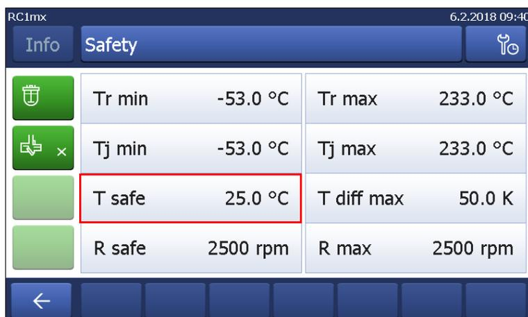
2 Voer een waarde in voor **T safe** die geldig is voor uw experiment.
