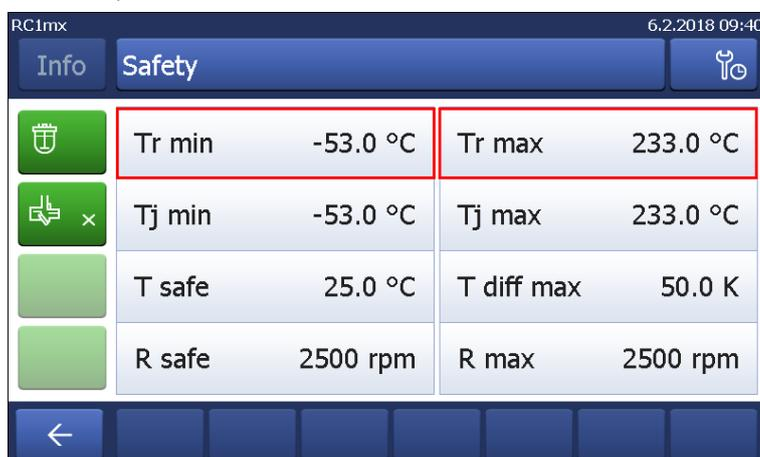
2 Voer een waarde in voor **Tr max** en **Tr min** die geldig is voor uw experiment.
