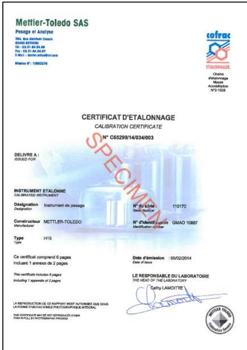
Un certificat d'étalonnage par instrument est émis comprenant le relevé de mesures, les erreurs d'indication, les incertitudes sur les erreurs d'indication ainsi que l'incertitude sur l'instrument de pesage sous forme d'équation.
