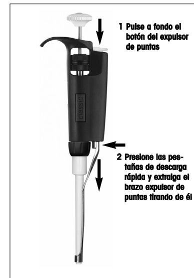
Figura 3 Retirada del brazo expulsor de puntas
